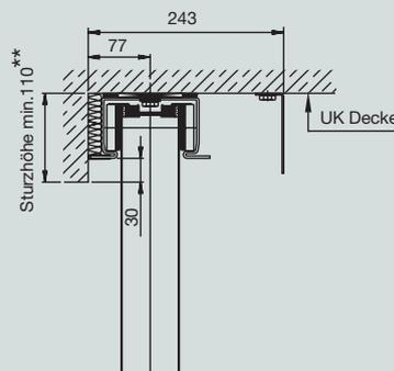
\*\* Bei einer Öffnungshilfe mit gleicher Flügelteilung: Sturzhöhe zusätzlich 80 mm
