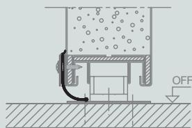
Torführung unten mit Edelstahlschiene
