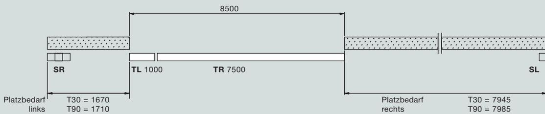
Wir zeigen den beidseitigen Platzbedarf für eine Öffnungsgröße von 8500 x 2500 mm mit ungleicher Teilung für ein 2-flügeliges Tor ohne Öffnungshilfe und ohne Nischenklappe.
